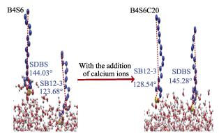
图 9 B4S6、B4S6C20 体系中 SB12-3 和 SDBS 极性头基 与疏水尾链之间的角度
