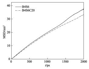
图 5 B4S6、B4S6C20 体系中水分子的均方位移 Fig. 5 Mean square displacement of water molecules in B4S6 and B4S6C20 systems
