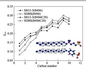
图 10 B4S6、B4S6C20 体系中 SB12-3 和 SDBS 的疏水 尾链序参数
