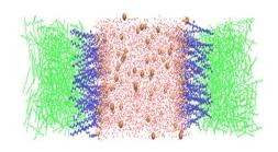
图 2 SB12-3/SDBS 表面活性剂复配体系初始状态下的模拟体系示意图 [n(SB12-3):n(SDBS)=4:6,绿色代表油相、蓝色代表 C原子、紫色代表 N原子、黄色代表 S原子、红色代表 O原子、白色代表 H原子、橙色代表 Na<sup>+</sup>]
