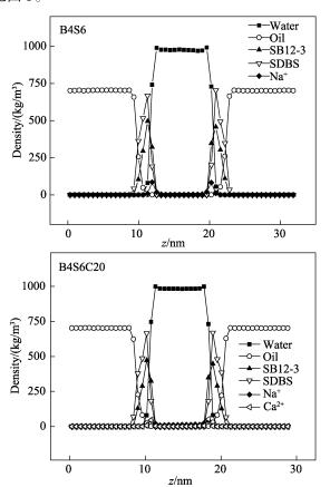
图 3 B4S6、B4S6C20 模拟体系中各组分沿 z 轴方向密度分布
