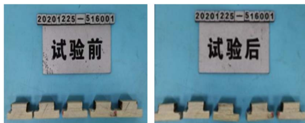
图 5 层剪切强度测试过程 Fig. 5 Interlaminar shear strength test process
