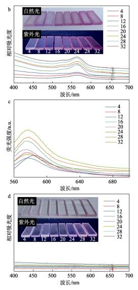
图 7 VMT/RB 薄膜的荧光谱图(a)和 UV-Vis 吸收谱图(b,插图为 VMT/RB 在自然光和紫外光下的照片)、RB@PVA 薄膜的荧光谱图(c)和 UV-Vis 吸收谱图(d,插图为 RB@PVA 在自然光和紫外光下的照片)
