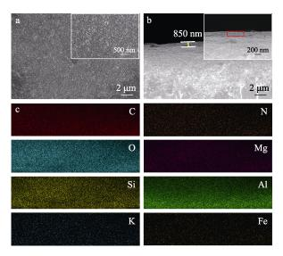
图 8 VMT/R6G@PVA 薄膜的表面 SEM 图(a)、截面 SEM 图(b) 和截面 Mapping 图(c)
