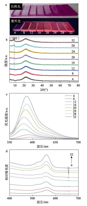
图 6 VMT/RB@PVA 的光学照片和在紫外光下的照片 (a)、XRD 谱图(b)、荧光谱图(c)和 UV-Vis 吸收谱图(d)
