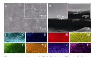
图 9 VMT/RB@PVA 薄膜的表面 SEM 图(a)、截面 SEM 图(b) 和截面 Mapping 图(c)
