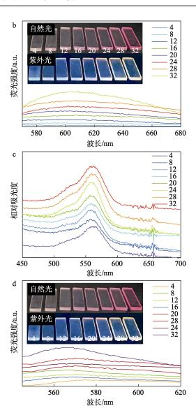
图 5 VMT/R6G 薄膜的 UV-Vis 吸收谱图(a)和荧光谱图(b, 插图为 VMT/R6G 在自然光和紫外光下的照片)、R6G@PVA 薄膜的 UV-Vis 吸收谱图(c)和荧光谱图(d, 插图为 R6G@PVA 在自然光和紫外光下的照片)
