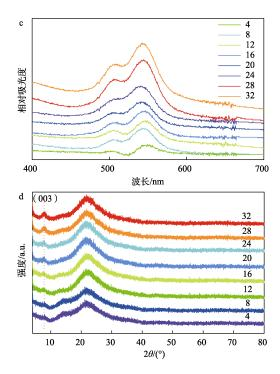
图 4 VMT/R6G@PVA 的光学照片和在紫外光下的照片 (a)、VMT/R6G@PVA 荧光薄膜的荧光谱图(b)、 UV-Vis 吸收谱图(c)和 XRD 谱图(d)
