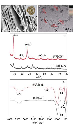
图 1 膨胀蛭石的 SEM 图(a, 插图为膨胀蛭石的光学照片)、剥离蛭石的 TEM 图(b, 插图为剥离蛭石的光学照片)、膨胀蛭石和剥离蛭石的 XRD 谱图(c)和 FTIR 谱图(d)
