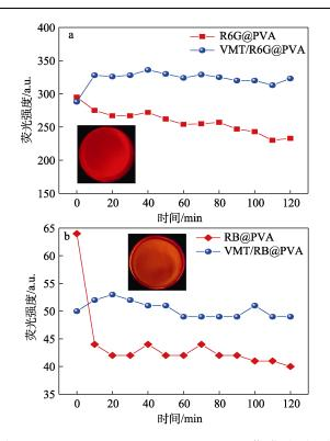
图 10 R6G@PVA 和 VMT/R6G@PVA 薄膜(a)及 RB@PVA 和 VMT/RB@PVA 薄膜(b)的抗紫外 光稳定性
