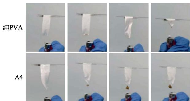
图 11 纯 PVA 隔膜与 A4 改性隔膜燃烧性能
