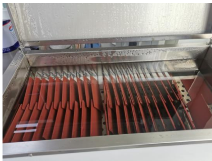
图 5 防污涂层吸水率测试示意图
