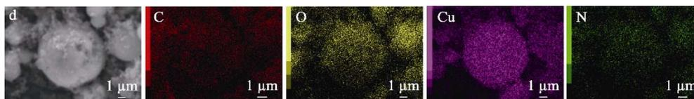
图 2 Cu-1/NC (a)、Cu-2/NC (b) 和 Cu-3/NC (c) 的 SEM 图; Cu-2/NC 的 EDX-mapping 图 (d)
