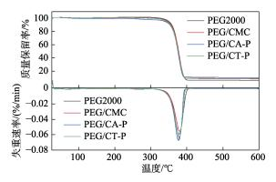
图 8 PEG2000 和 PEG/CMC、PEG/CA-P 和 PEG/CT-P 复合相变材料的 TGA 曲线
