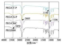
图 6 PEG2000、PEG/CMC、PEG/CA-P 和 PEG/CT-P 复合相变材料的 FTIR 谱图
