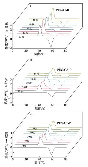
图 11 PEG/CMC(a)、PEG/CA-P(b)、PEG/CT-P(c) 复合相变材料的 50 次热循环曲线
