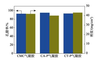
图 4 不同气凝胶的孔隙率和密度
