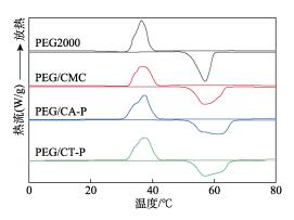
图 9 PEG2000、PEG/CMC、PEG/CA-P 和 PEG/CT-P 复合相变材料的 DSC 曲线
