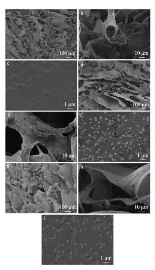
图 3 CMC 气凝胶 (a~c)、CA-P 气凝胶 (d~f) 和 CT-P 气凝胶 (g~i) 在不同放大倍数下的 SEM 图
