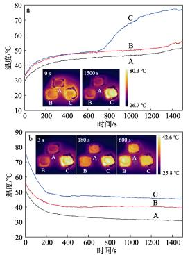
图 10a 插图是氙灯辐射 0 和 1500 s 后样品的热成像图;图 10b 插图是氙灯关闭后 3、180 和 600 s 的热成像图
