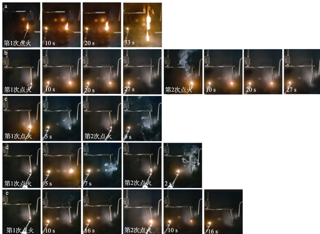
图 6 UL-94 测试过程中 EP1 (a)、EP2 (b)、EP3 (c)、EP4 (d) 和 EP5 (e) 的视频截图
