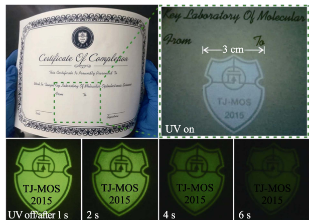
图 7 印刷在纸张上的图案的长余辉发光照片 [35] Fig. 7 Long afterglow photo of patterns printed on paper [35]
