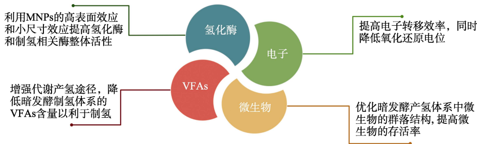
图 9 MNP 在暗发酵过程中的作用机制
