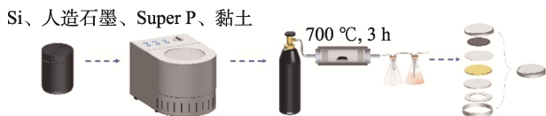
图 1 三维硅碳负极材料的制备过程示意图
