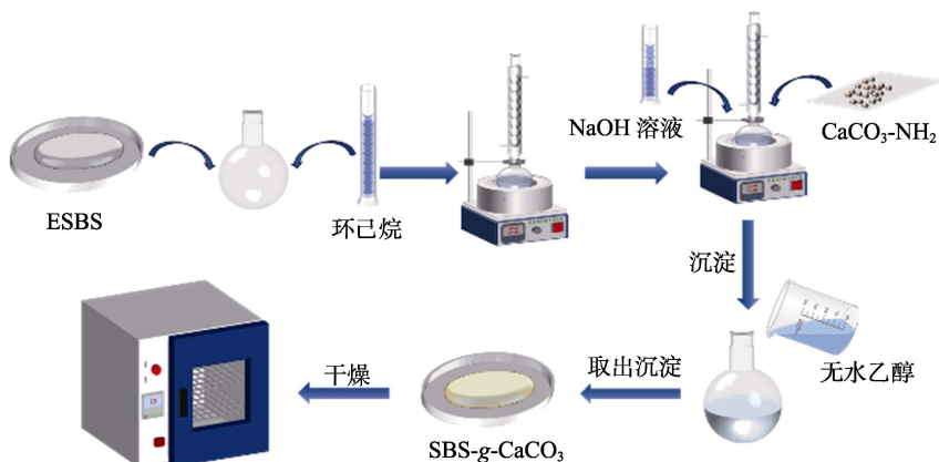
图 1 \text{SBS-g-CaCO}_3 的制备流程示意图
