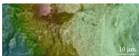
图 11 应变 150%时的 E-HTPB-PU-15%的荧光和 SEM 图 Fig. 11 Luminescence and SEM image of E-HTPB-PU-15% at strain 150%
